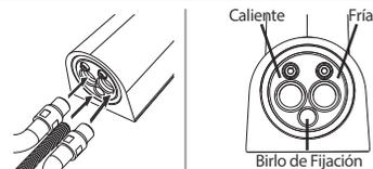
Rosque una de las mangueras (caliente) en el barreno izquierdo y la otra manguera (fría) en el barreno derecho de la Nariz (1).
