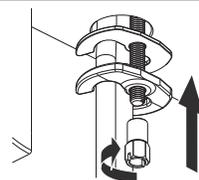
Por debajo del lavabo o loza introduzca en el Birlo de Fijación (4a) el Empaque Herradura (4b) y la Herradura de Fijación (4c), después apriete la Contratuercas (4d) en el Birlo hasta fijar firmemente.
