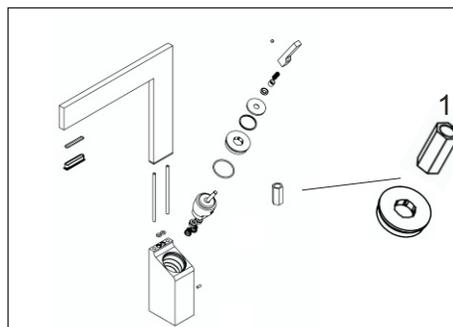
El dado hexagonal (1) se utilizara para desatornillar el anillo que se encuentra en la parte superior del cartucho, cuando se requiera reemplazarlo por mantenimiento o sustitución.
