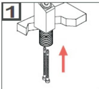
1. Conecte las mangueras en la parte inferior de su mezcladora o Monomando.
