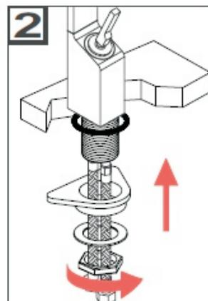
2. Coloque el empaque negro en el cuerpo central, inserte el cuerpo central en el agujero del fregadero introduciendo primero el soporte de plástico blanco, seguido por la rondana y la tuerca, posteriormente ajuste la tuerca en el vástago del cuerpo central, tal y como se indica en el dibujo.
