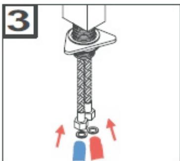
3. Identifique las tomas de agua (fría y caliente) y realice las conexiones. Posteriormente verificar que no existan fugas.
