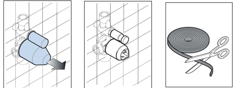
1-Instale el monomando y conéctelo a la red hidráulica, el agua caliente debe ser instalada en la entrada izquierda del monomando y el agua fría al lado derecho del monomando. Realice el terminado del muro y retire los tapones protectores.
