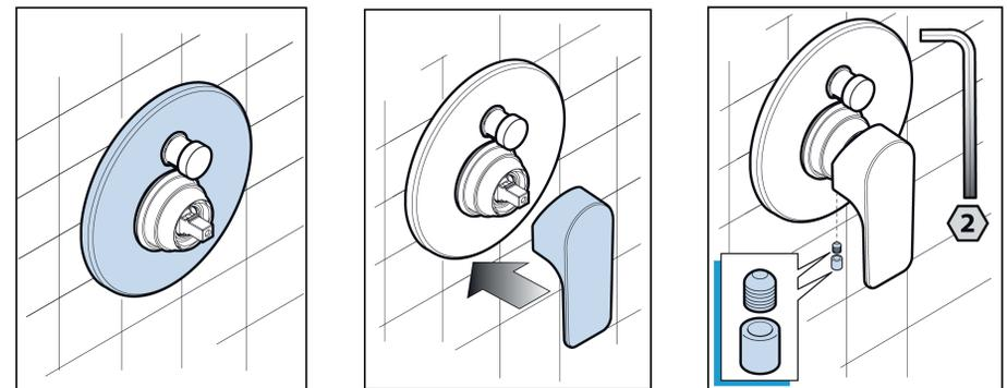
3-Por último coloque la maneta en el vástago del monomando de forma tal que la palanca de la maneta quede apuntando hacia abajo. En seguida, apriete el opresor con la llave hexagonal y coloque a presión el tapón.
