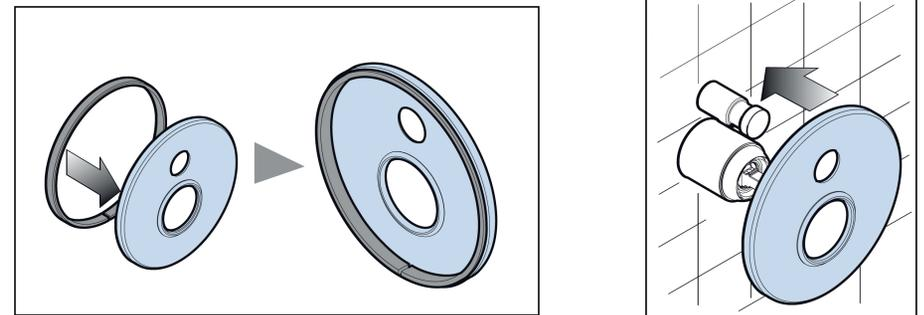
2-Colocar alrededor del chapeton por la parte interna la cinta para instalación y cortar el excedente. Coloque a través del cuerpo del monomando a presión el chapeton, asegúrese que el chapeton llegue hasta el final del muro terminado y alinéelo.
